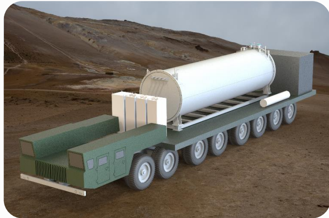
Проект мобильного СПИНа мощностью до 1 ГДж (5МВт; 180 с)
