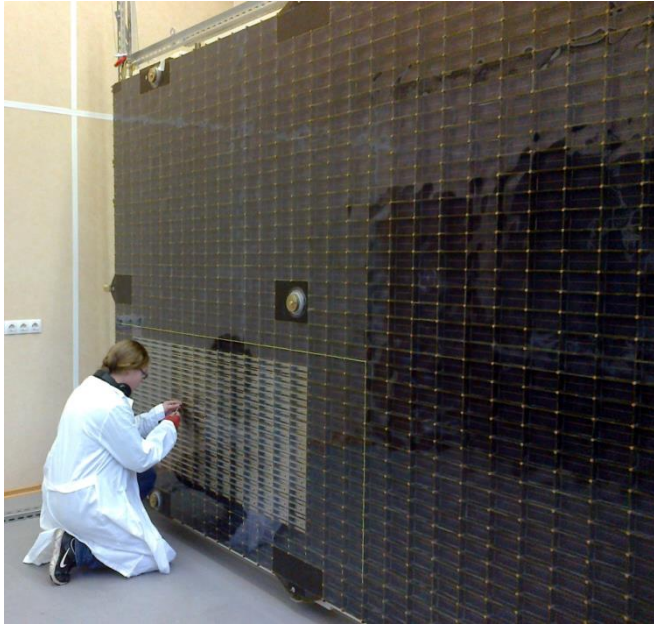
Макет первой отечественной солнечной батареи ( 10\text{м}^2 ) с линзовыми концентраторами излучения и каскадными солнечными элементами
