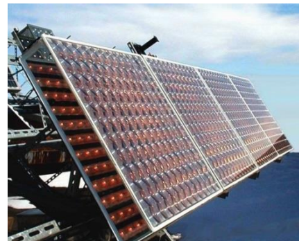
Концентраторная батарея (1м 2 ) на основе 576 субмодулей
