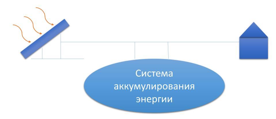
Автономные системы энергоснабжения на основе солнечных энергоустановок требуют систем аккумулирования энергии с большой емкостью хранения для обеспечения гарантированного энергоснабжения в зимние временные периоды
