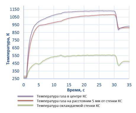
Проведены экспериментальные исследования по генерации пара в экспериментальном образце водородного парогенератора. Температура генерируемого пара составила 950...1180 К. Установлено, что при увеличении длины охлаждаемой вставки в 2 раза (с 35 до 70 мм), произошло снижение концентрации окислов азота с 38 до 14 мг/нм<sup>3</sup>, что существенно ниже требований, предъявляемым даже к перспективным камерам сгорания газотурбинных установок.
