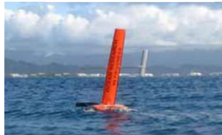
Рис. 8. Схема устройства поверхностного АНПА «SDRONE», использующего энергию ветра (снизу) и этот аппарат в океане (сверху).
